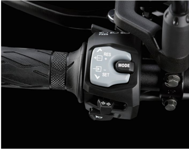
Left hand switchgear
